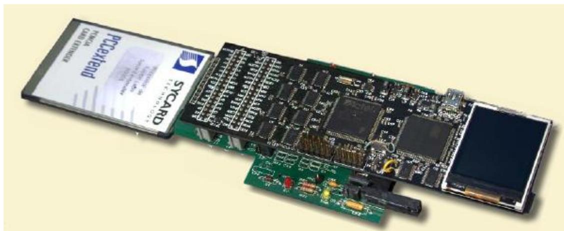
SkyDigita CAM 侦测仪是一款高效并随时可得的 DVB-CI/CI+开发和测试工具, 它能侦测主机和 CAM 模块之间的 CI 接口通信情况并且可以仿真任何一方。
